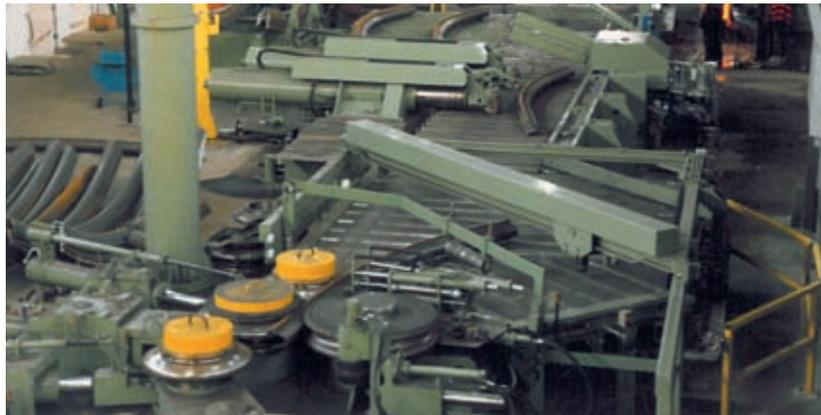
**Трехмерная гибочная головка**
