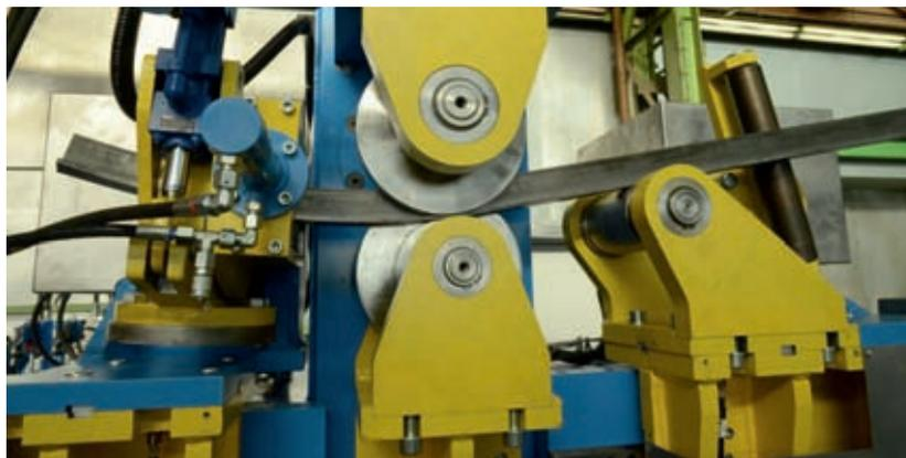
**Машина для гибки трубчатых панелей**
